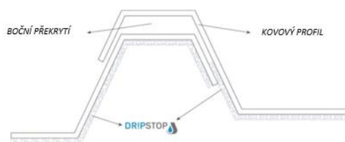
Grafika 8: Řádný podélný spoj kovových profilů
